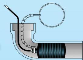
**Absperrbälle für bestimmte Rohrdurchmesser**
